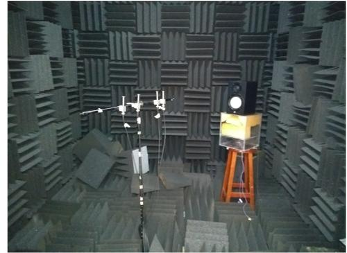
(b) Sistema de medição na câmara anecoica FEM. Arranjo de microfones com distância coprima [21] mais fonte
